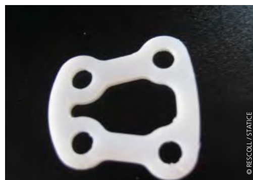
Plaque d'ostéosynthèse issue de la technologie composite : Verre Bioactif/Copolymère d'acide lactique
