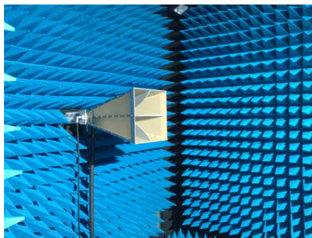
Chambre anéchoïde : chambre d'essai Keytek G-Strip // Amplificateurs radiofréquence de puissance, jusqu'à 100W à 1GHz // Sonde de champ isotropique
